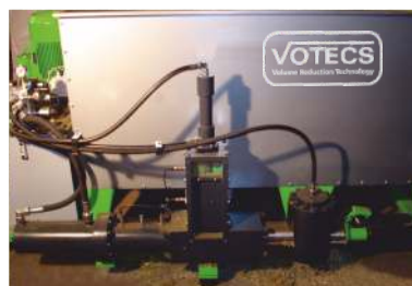
Brikettierpresse AP 555 unter Filteranlage eingebaut
