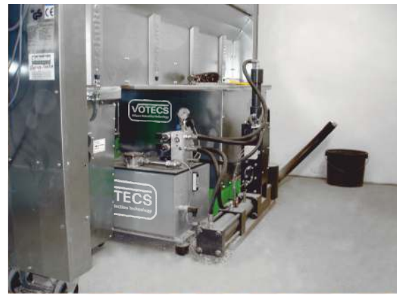
Brikettierpresse AP 555 unter Filteranlage eingebaut
