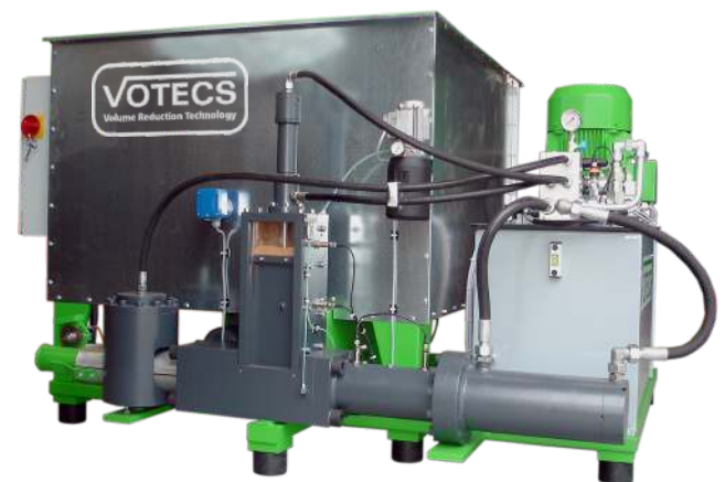
Brikettierpresse AP 775 mit 150 kg/h Durchsatzleistung, 70 mm Brikettdurchmesser
