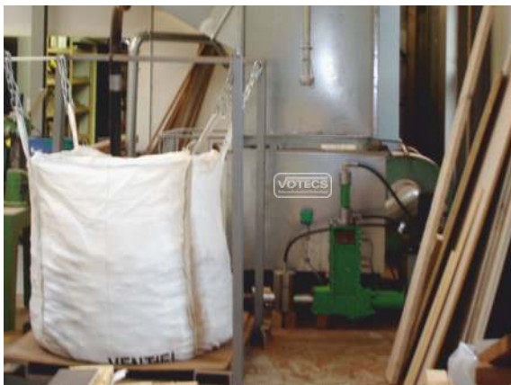
Brikettierpresse AP 675 unter Filteranlage eingebaut
